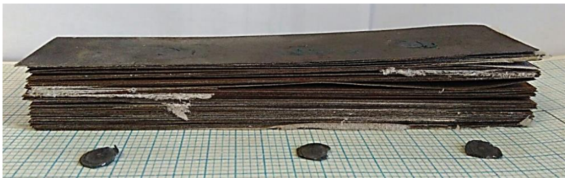
Рис. 1.9 Результат випробувань при нерівномірному пресуванні осердя статора у вигляді «жолоба»
