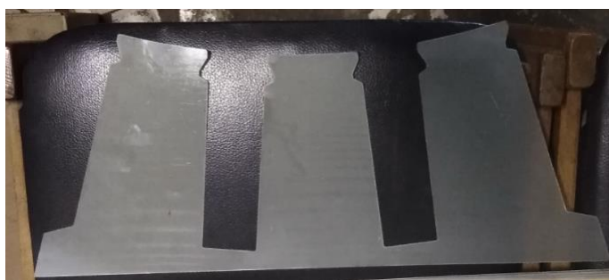
Рис. 1.34 Клин для усунення дефектів по внутрішньому периметру
