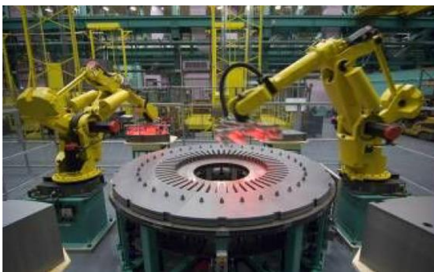
Рис. 1.35 Роботизована лінія виготовлення осердь ТГ
