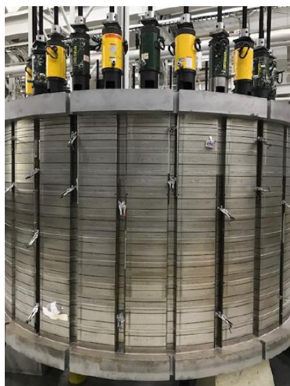
Рис. 1.36 Процес пресування осердя
