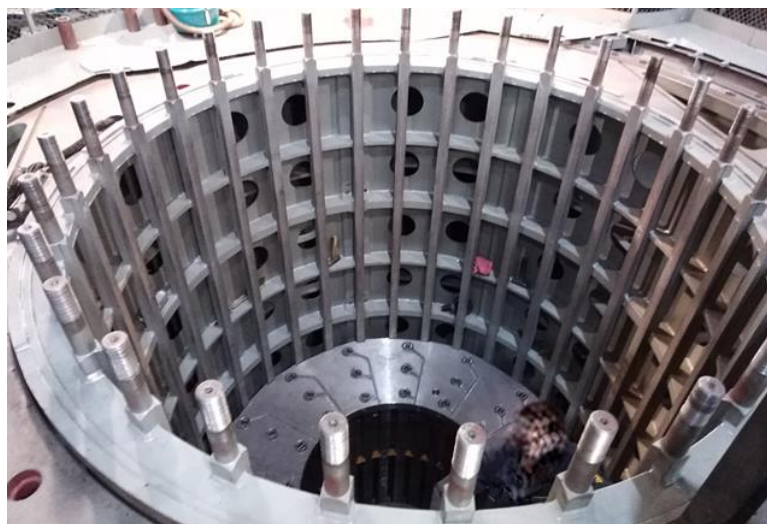
Рис. 1.28 Процес складання та пресування ТГ
