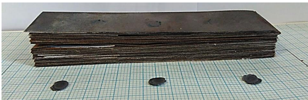
Рис. 1.7 Результат випробувань при рівномірному розташуванні матеріалу між пластинами
