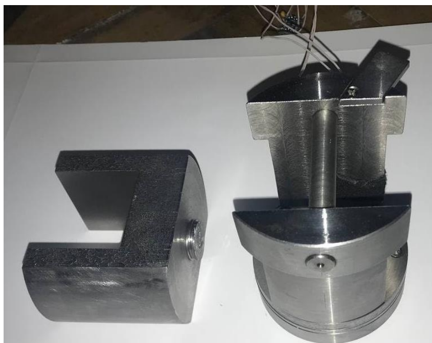
Рис. 4.15 Вимірювальна комірка з вторинним вимірювальним перетворювачем
