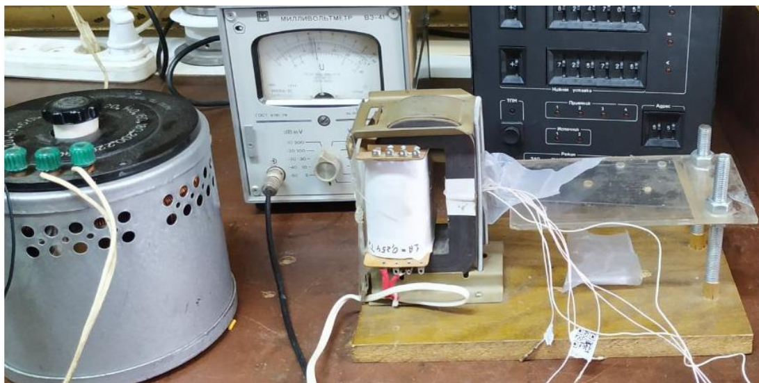
Рис. 4.3 Стенд для проведення випробувань впливу магнітного поля промислової частоти на стабільність функціонування перетворювача "ємність-код"
