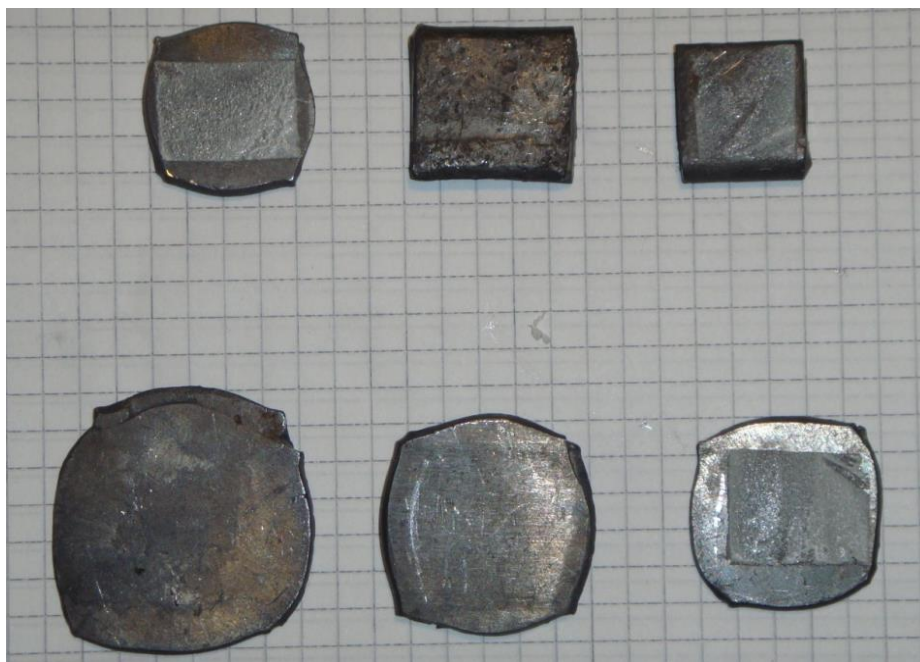
Рис. 1.32 Проби з різним ступенем деформації
