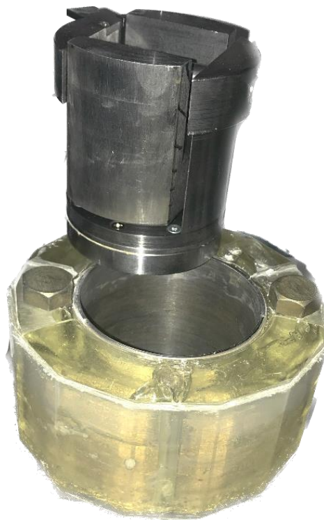
Рис.4.14 Вимірювальна комірка із фрагментом моделі натискного кільця
