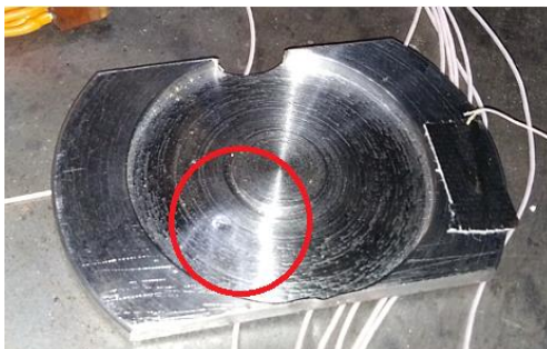
Рис. 4 – Дослідний зразок мембрани вид знизу після деформації
