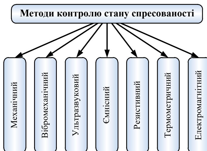
Рис.1.13 Систематизація методів контролю стану спресованості осердя статора потужних генераторів
