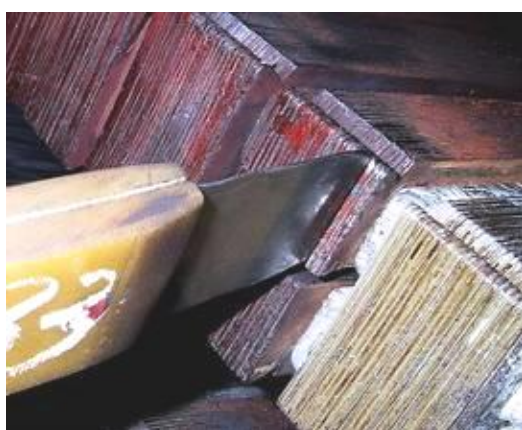
Рис. 1.15 Ознаки ослаблення пресування активної сталі [3]:
