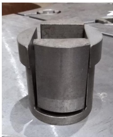
Рис. 1.31 Натурний зразок вимірювальної комірки
