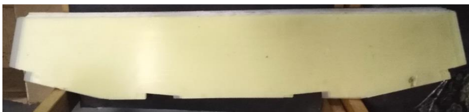
Рис. 1.33 Клин для усунення дефектів по зовнішньому периметру
