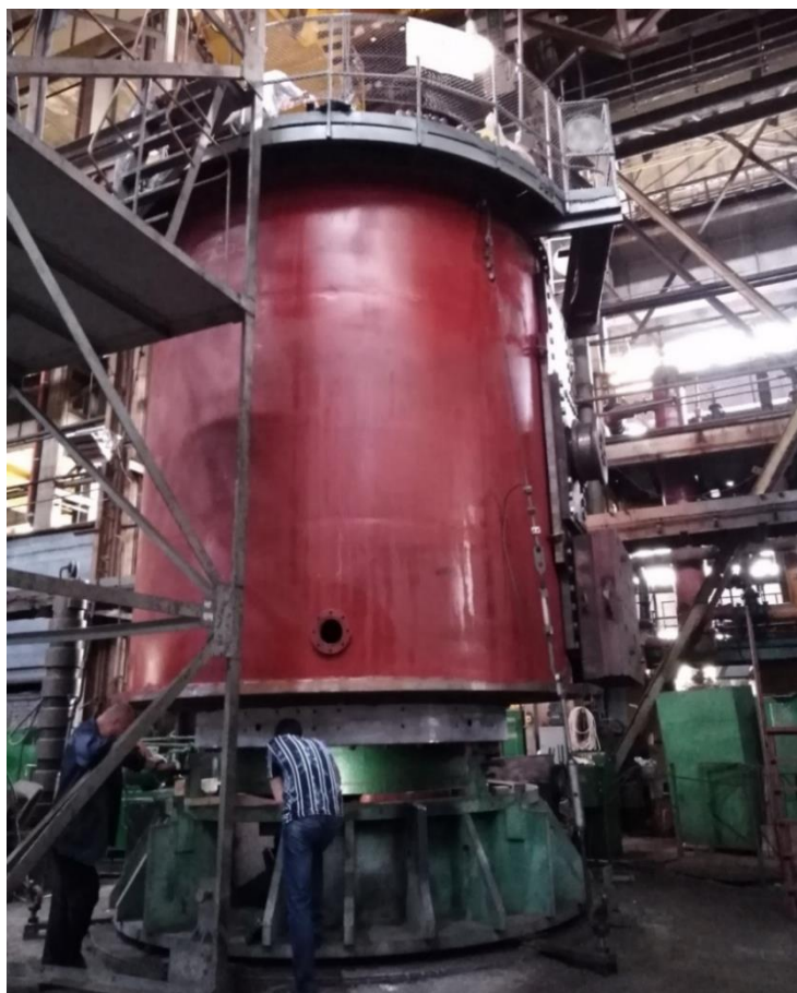
Рис. 1.3 Статор ТГВ 200 на пресі
