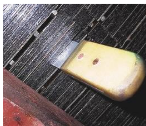
Рис. 1.15 Ознаки ослаблення пресування активної сталі [3]:
