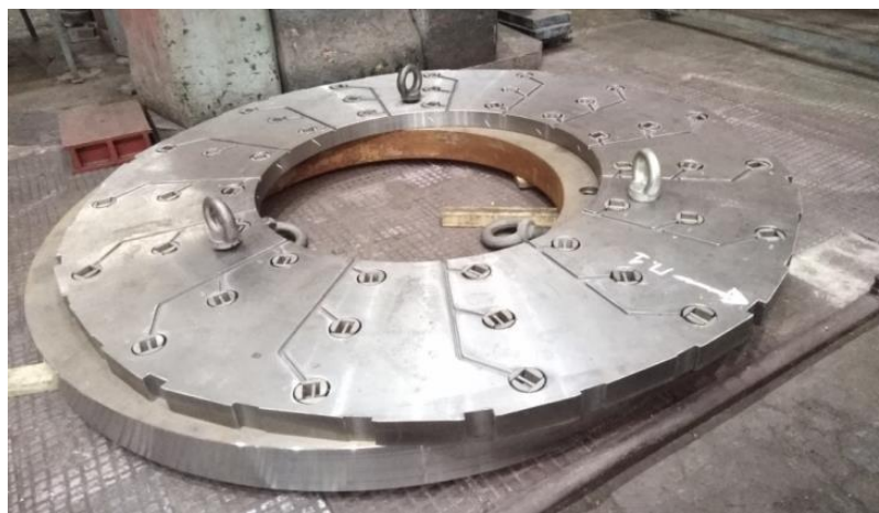
Рис. 2.3 Нижнє додаткове кільця із встановленими вимірювальними комірками
