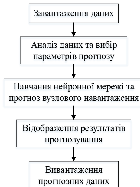
Рис. 2.4 Блок схема комп'ютерної моделі прогнозування вузлового навантаження.
