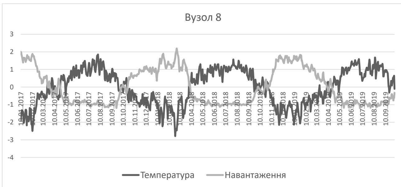
Рис. 4.6 Графіки співвідношення навантаження та температури для вузла №8
