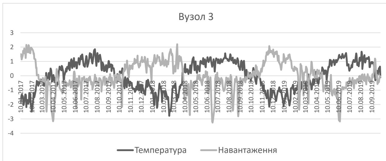
Рис. 4.4 Графіки співвідношення навантаження та температури для вузла №3
