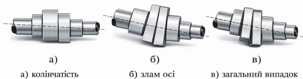
Рис. 1.3 Дефекти сполучення жорстких (напівжорстких) муфт
