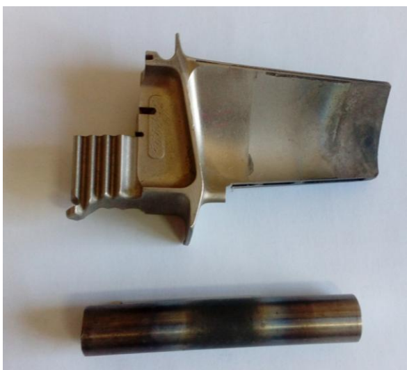
Рис. 4.22 Деталі, які нагріваються для пайки
