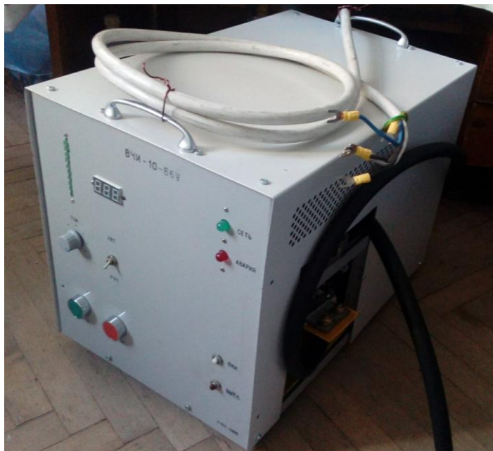
Рис. 4.20 Зовнішній вигляд установки «ВЧИ-10-66-У» потужністю 10кВт, частотою 66кГц
