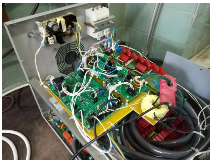
Рис.4.15 Внутрішній вигляд установки індукційного нагрівання «ВЧІ-5»
