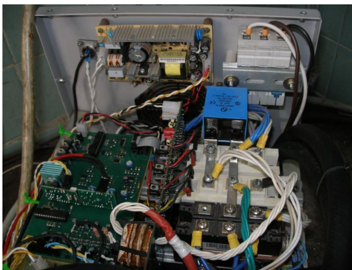
Рис. 4.21 Внутрішній вигляд установки «ВЧИ-10-66-У» потужністю 10кВт, частотою 66кГц
