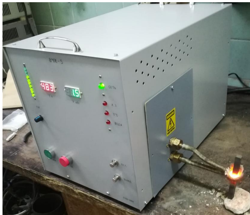
Рис. 4.14 Зовнішній вигляд установки індукційного нагрівання «ВЧІ-5»
