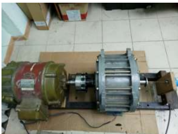
Рис. Б.1 Зовнішній вид розробленого стенду для дослідження тихохідного асинхронного двигуна
