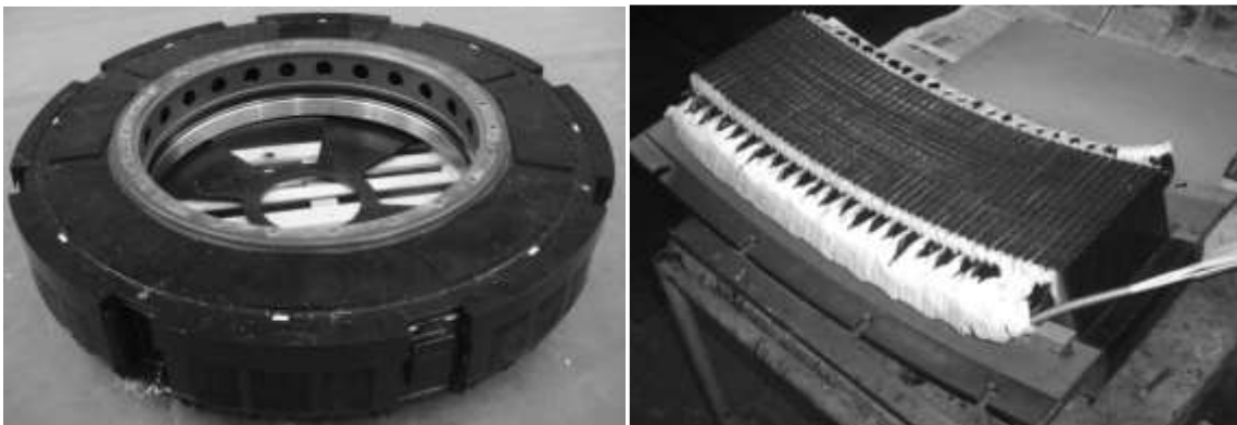
Рис. 1.5 Асинхронний дугостаторний двигун та індуктор з обмотками
