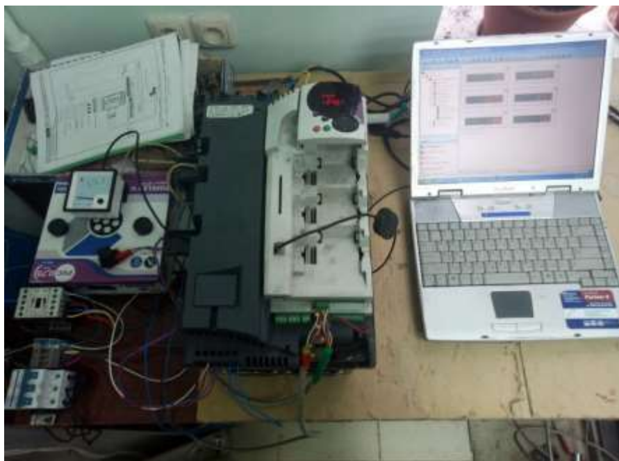
Рис. Б.2 Силова частина стелу для дослiдження тихохiдного асинхронного двигуна
