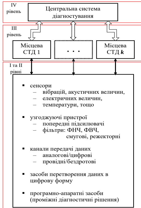
Рис. 3.6 Структура розподіленої багаторівневої системи моніторингу стану та діагностики ЕО
