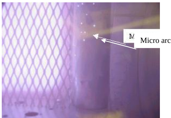
Рис. 6.7 Спостереження іскрових розрядів
