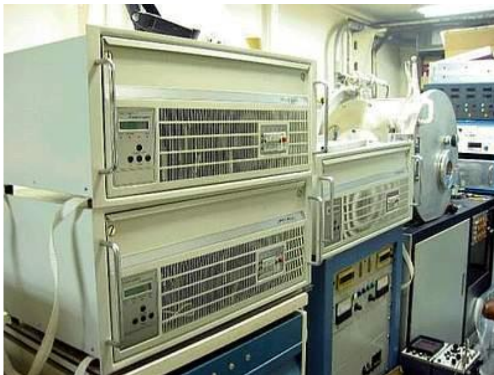
Рис. 6.2. Джерела зміщення в складі технологічної установки компанії Phygen Inc. (США).
