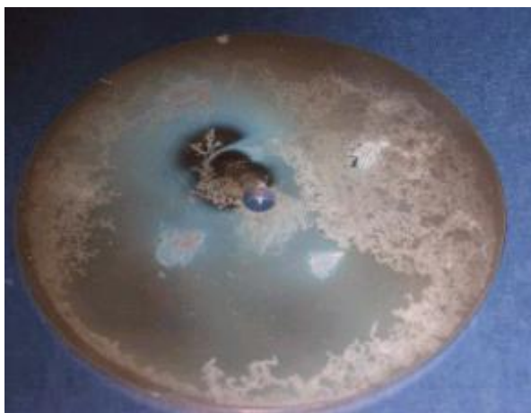
Рис. 6.9 Незгладимий слід на деталі при виникненні електричної дуги
