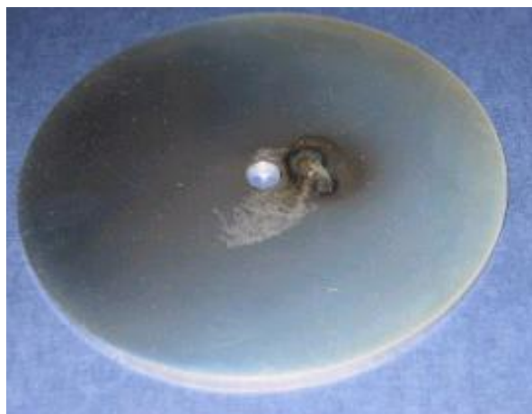
Рис. 6.10 Результат напилення дослідного зразка, при частоті реверса 100Гц і тривалості імпульсів 2мс
