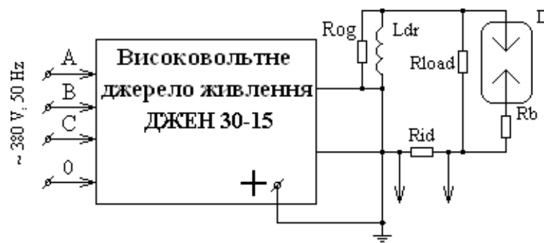
Рис. 6.23 Схема досліджень динамічних характеристик високовольтного джерела живлення «ДЖЕН 30-15»
