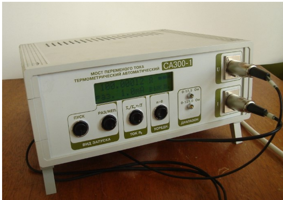
Рис. 6.10. Зовнішній вигляд моста СА300-1
