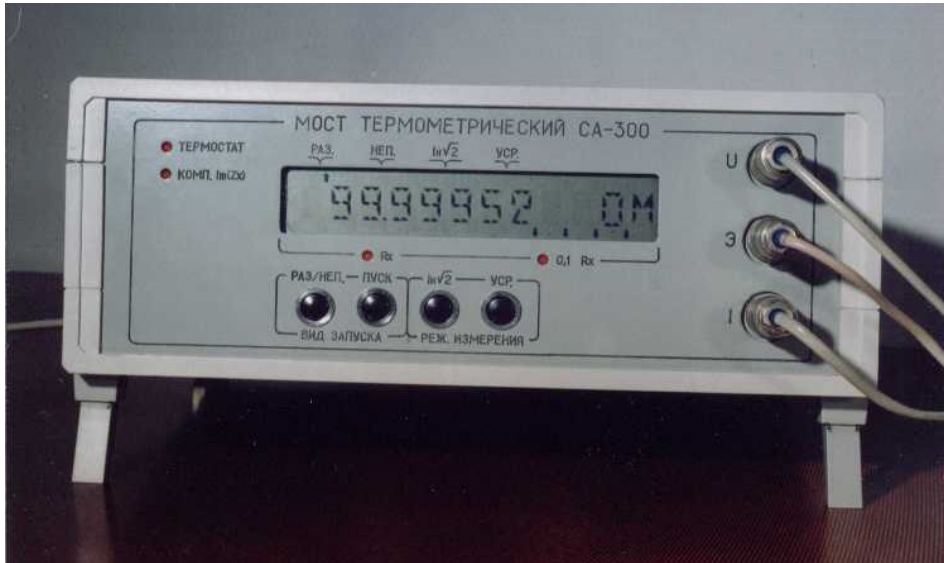
Рис. 6.9. Зовнішній вигляд моста СА300
