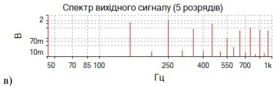
Рис. 4.9. Осцилограми вихідного сигналу п'ятирозрядного ВЦАП, змодельована (а), знята з експериментального зразка (б) і його спектр (в)
