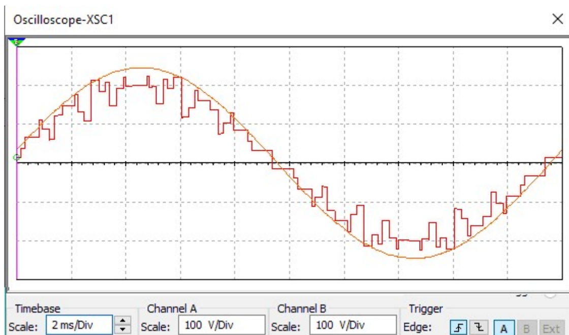
Рис. 3.22. Вихідний сигнал змодельований в схемному симуляторі, до ФНЧ і після фільтра
