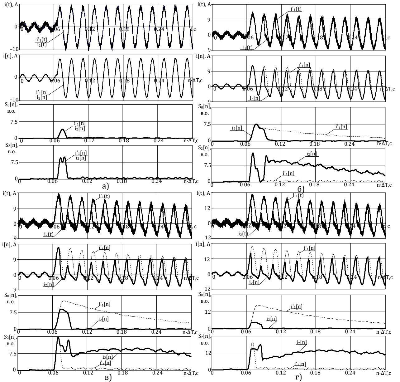
Рис. 3.4. Спектральні характеристики струмів ПВК за умов КЗ та присутності
