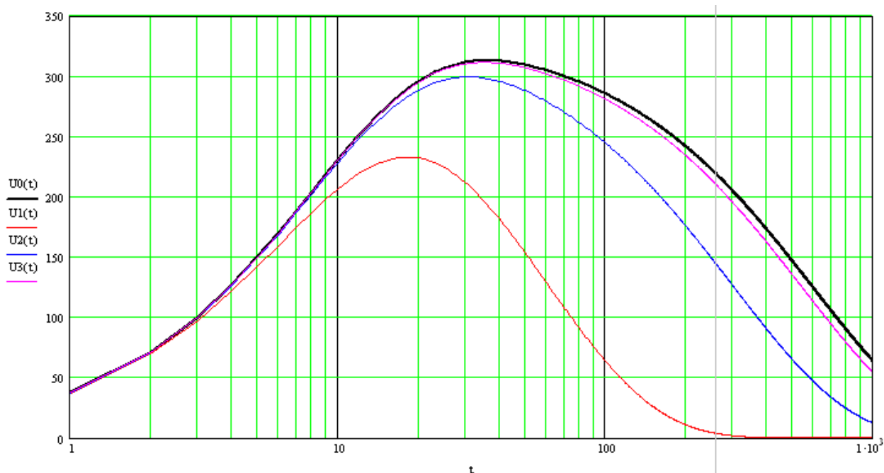
Рис. К.5 Часової залежності величини поверненої напруги при різних значеннях вхідного опору вимірювального приладу, чорна крива - ідеалізована, фіолетова, синя та червона криві для значень внутрішнього опору вимірювального приладу (10, 1 і 0,1) \cdot R відповідно
