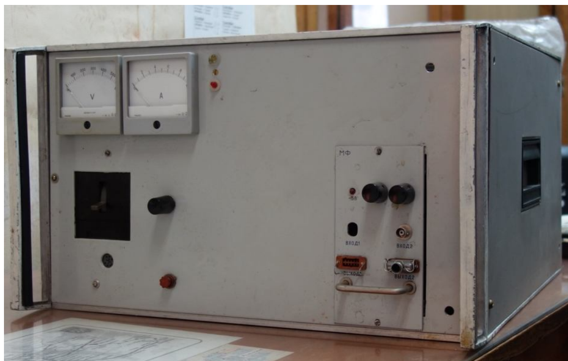
Рис. М.1 Регульованні транзисторні електророзрядні установки ЭРУ-5-0,5/1 – a та ЭРУ- 3-0,3/0,5 – б
