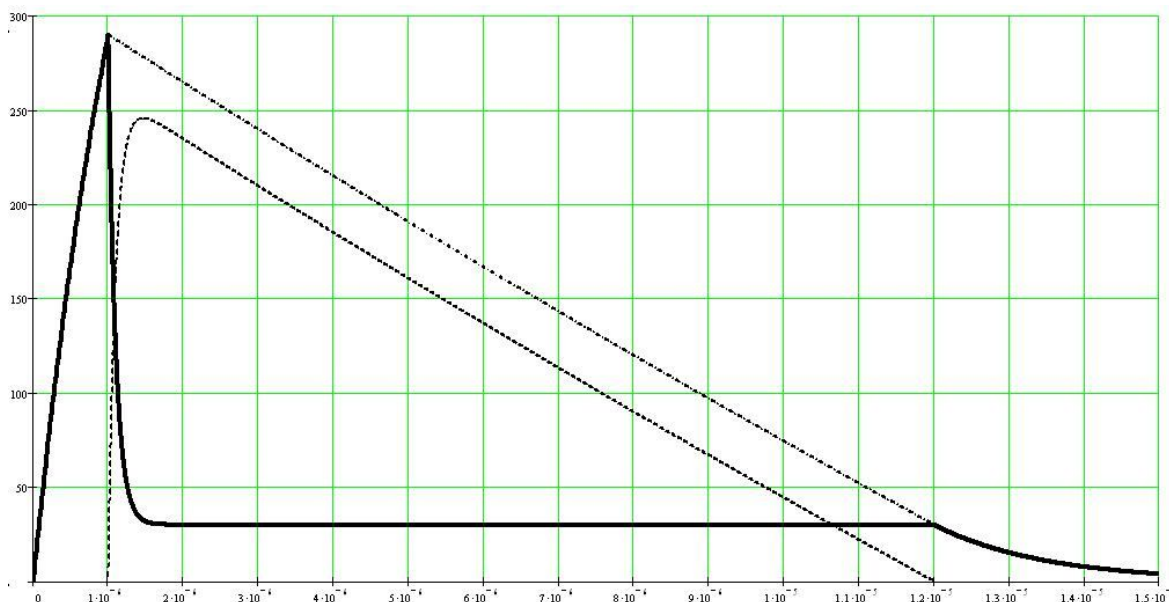
Рис. 4.10 Часові залежності струмів в електричному навантаженні – сполошна крива, розрядному контурі – пунктирна крива та шунтувальному ланцюгу – штрих-пунктирна крива
