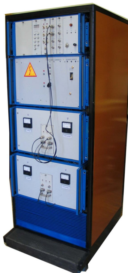
Рис. М.1 Регульованні тиристорні електророзрядні установки ЭРУ-6-0,5/1– а (одноканальна), ЭРУ-5-0,8/1,5 – б (одноканальна) та ЭРУ-0-1,2/0,3 – в (двоканальна)
