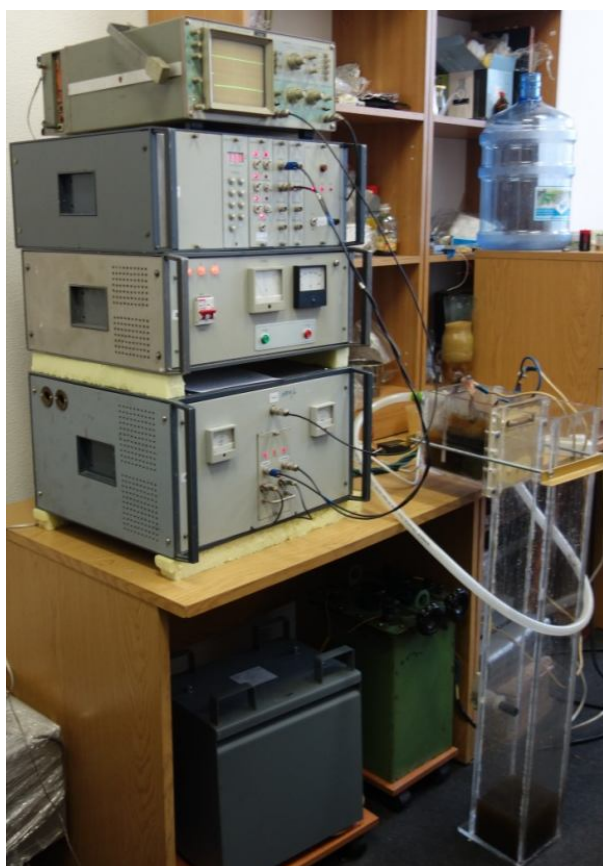
Рис. М.1 Регульованні тиристорні електророзрядні установки ЭРУ-6-0,5/1– а (одноканальна), ЭРУ-5-0,8/1,5 – б (одноканальна) та ЭРУ-0-1,2/0,3 – в (двоканальна)
