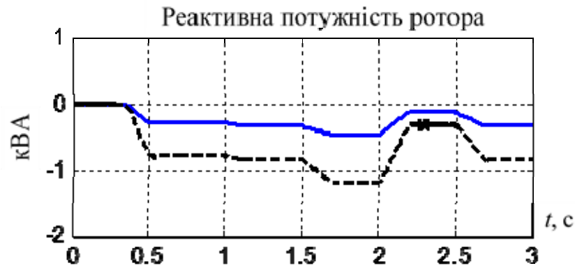
Рис. 2.6. Перехідні характеристики під час відстеження траєкторії моменту при ортогональному керуванні (пунктирна лінія) і при керуванні з мінімізацією втрат (суцільна лінія)
