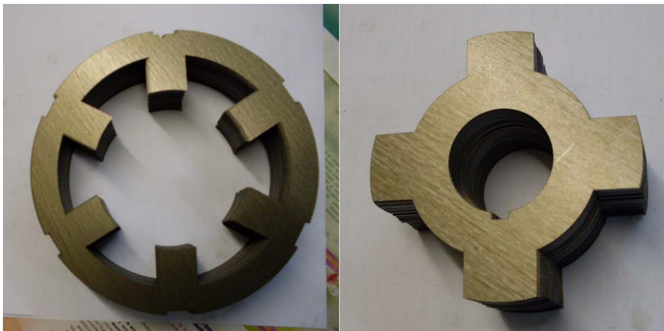
Рисунок 5.2 Фрагменти статорного (а) і роторного (б) пакетів індукторної машини
