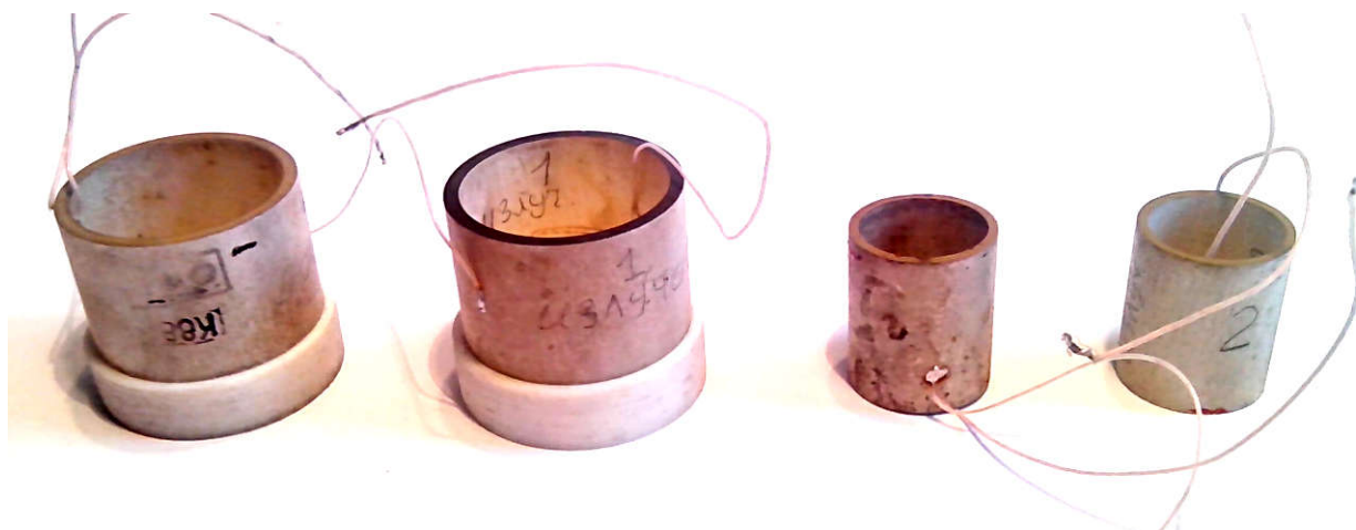
Рис. 3.9 Зовнішній вигляд зразків 2х типів п'єзокварцевих елементів
