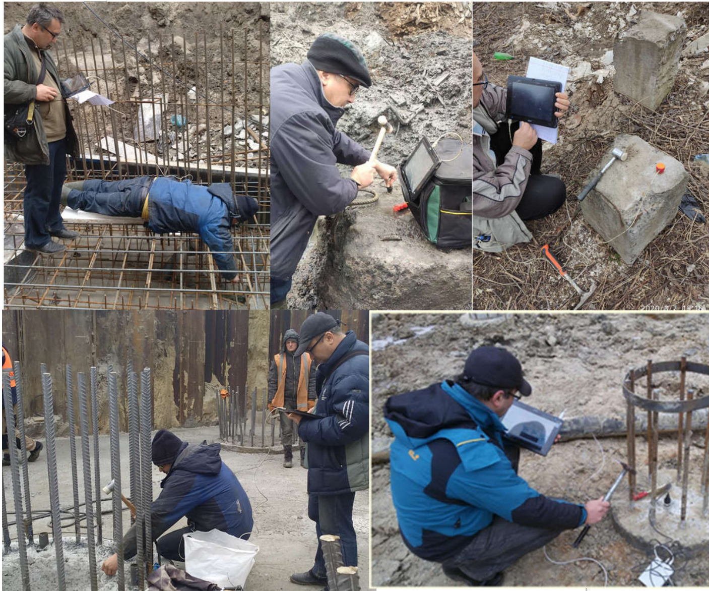
Рис. 4.17 Обстеження різних видів паль луна методом
