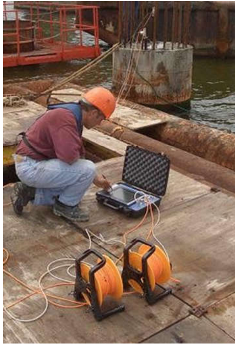
Рис. 1.21 Обстеження палі методом акустичного каротажу з використанням приладу англійської фірми PILETEST
