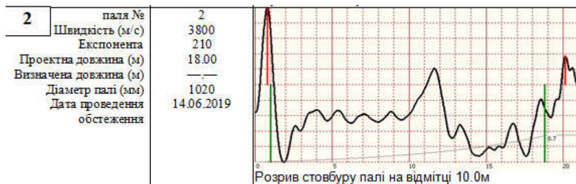
Рис. 4.13 Акустичні профілі: вгорі – багатоканальний каротаж, внизу – результати луна-методу
