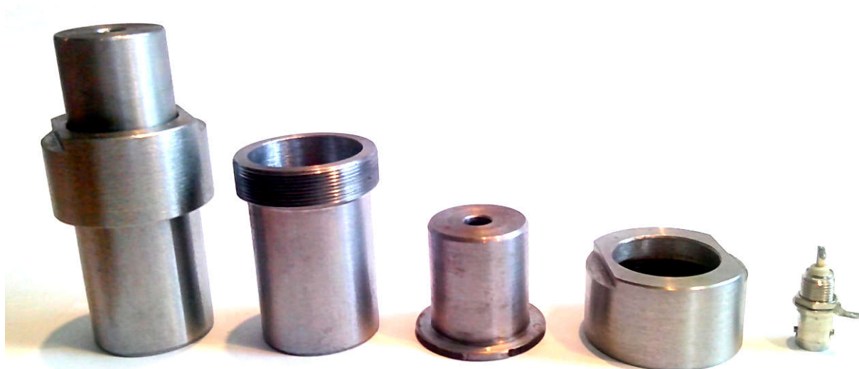
Рис. 3.10 Зовнішній вигляд датчика і його конструктивних елементів
