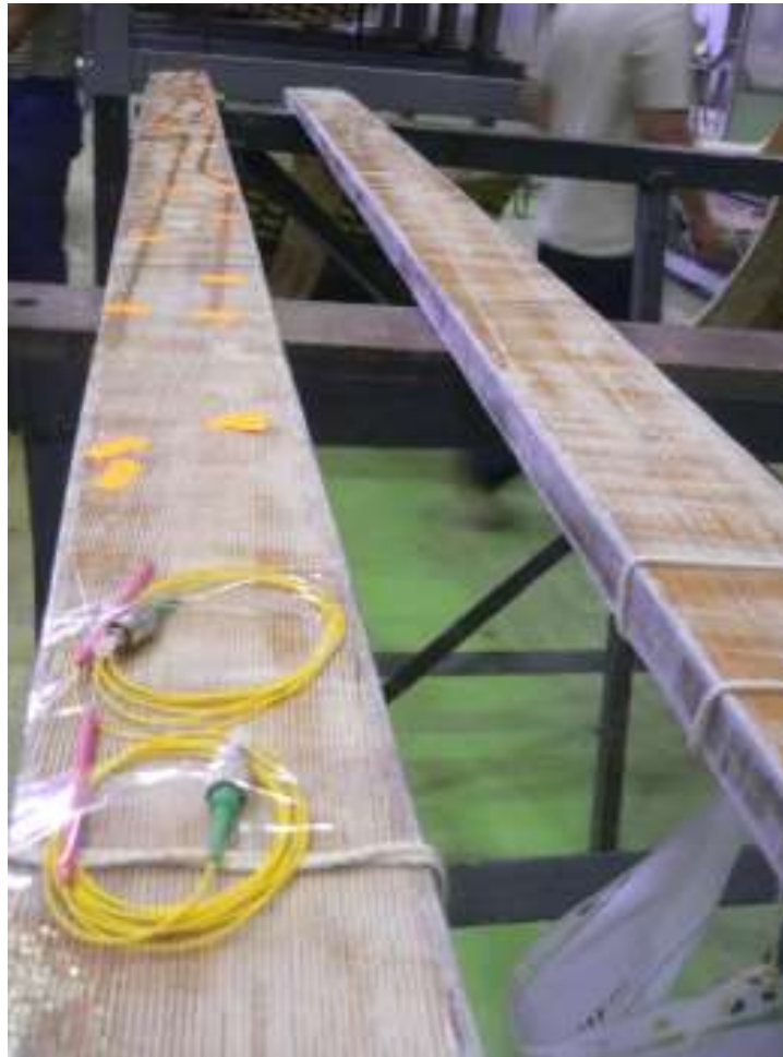
Рис. 1.7 Система вимірювання місцевих температур стрижнів на основі бреггівських комірок для турбогенератора потужністю 225 МВт
