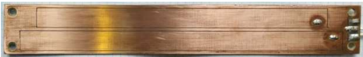
Рис. 4.5 Дослідний зразок ємнісного сенсора повітряного зазору
