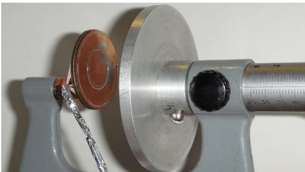
Рис. 6.21 Загальний вигляд ємнісного сенсора биття вала з концентричними компланарними електродами на випробувально-вимірювальному стенді
