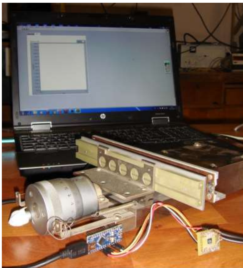
Рис. 6.1 Загальний вигляд комп'ютеризованої системи діагностування повітряного зазору з компланарним ємнісним вимірювачем
