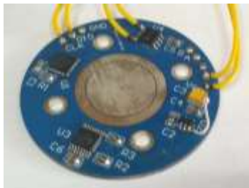
Рис. 1 – Ємнісний вимірювач зусилля пресування осердя статора турбогенератора
