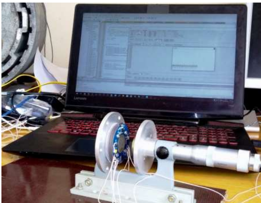
Рис. 6.16 Випробувально-вимірювальний стенд компонентів комп'ютеризованої системи контролю зусиль пресування осердя статора при складанні
