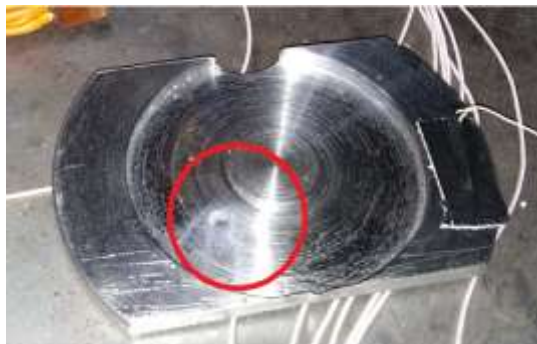
Рис. 4 – Дослідний зразок мембрани вид знизу після деформації
