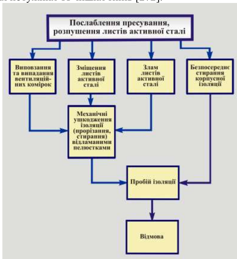
Рис. Г.6 Схема розвитку дефектів осердя статора ТГ, пов'язаних із послабленням пресування осердя
