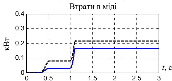
Рис. 2.8. Порівняння втрат у міді за ортогонального керування (пунктирна лінія) і за керування з мінімізацією втрат (суцільна лінія)
