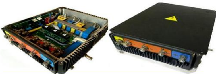
Експериментальний зразок системи керування (контролер) вентилювальним електродвигуном на постійних магнітах (400В, 50 / 100 кВт)
