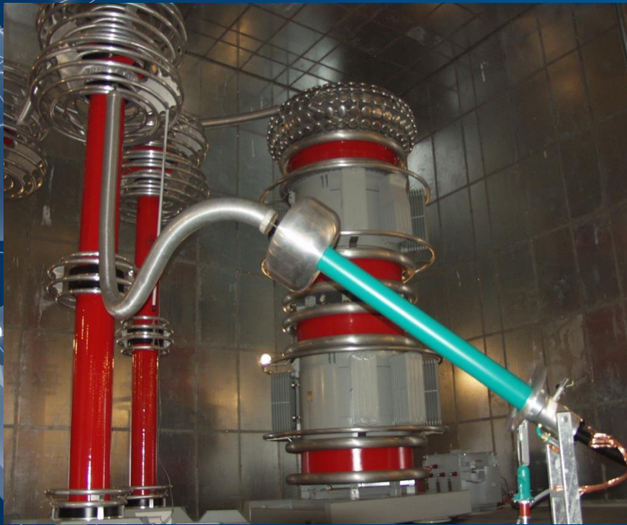
Резонансна система іспитів надвисоковольтних кабелів
