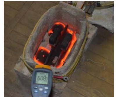
Нагрівання чавунного тормозного башмака редуктора вагону метро
